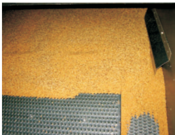
圖 11. 鋼板方型平底倉（稻穀藉由左側大片孔板吹出氣流向右側移動，再由右側小片孔板吹出氣流向底側移動到出料螺旋輸送機）
