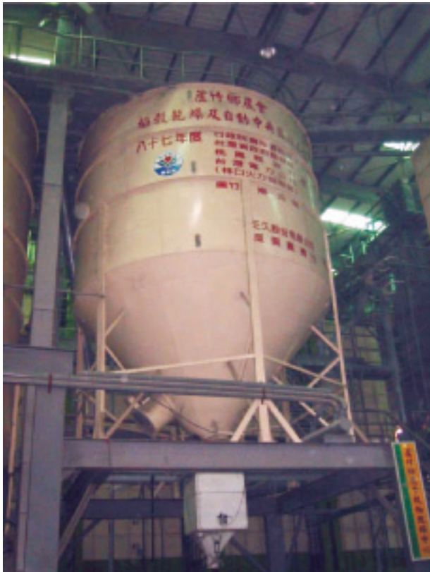
圖 19. 小型筒倉附設常溫通風機（乾燥中心濕穀暫存筒）
