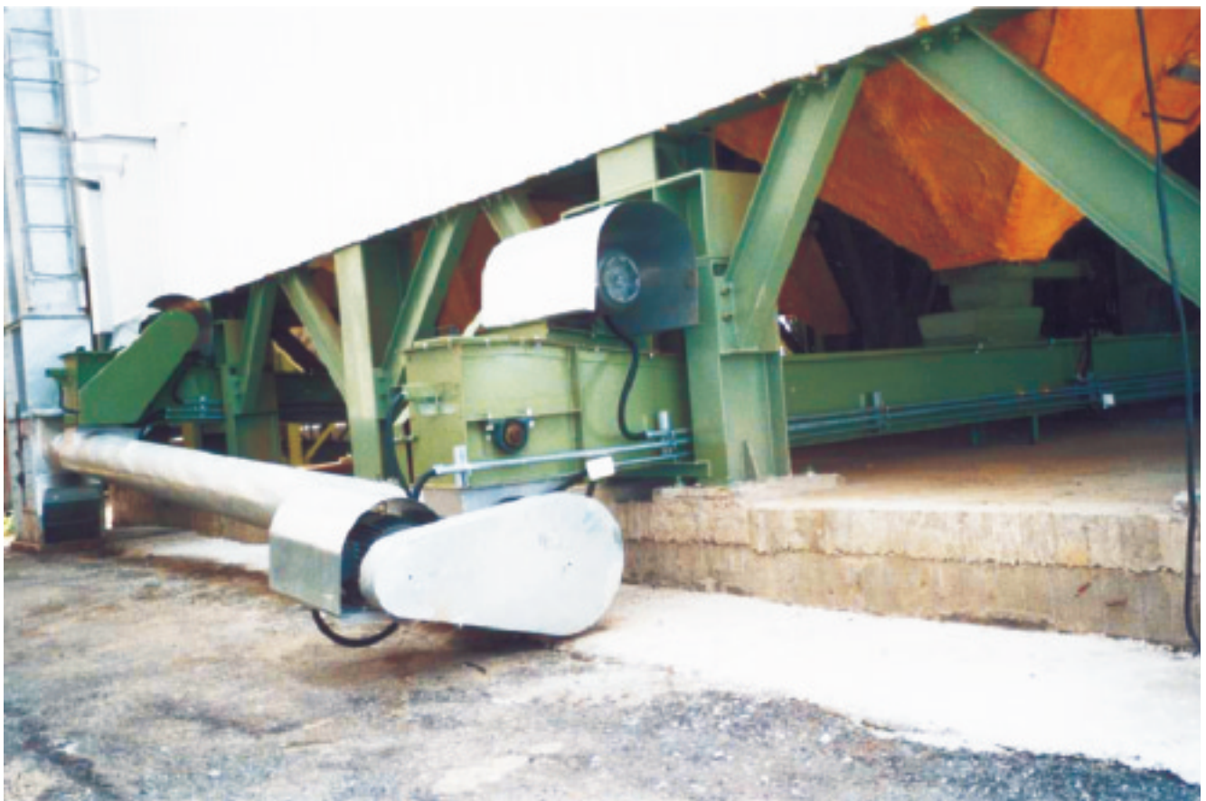
圖 18. 鋼板方型筒倉倉底出料螺旋輸送機（左下角）和鏈條輸送機（右下角）
