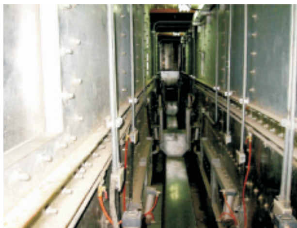
圖 10. 鋼板方型平底倉（中央底部為出料螺旋輸送機、其左右側為平底倉）
